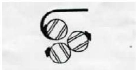
6. ДЛЯ СНЯТИЯ ГОТОВОГО ИЗДЕЛИЯ – открыть замок откидного вальца, подняв ручку и повернув рычаг. Откинуть вал.. Снять деталь. При недостаточной длине материала или ненадлежащем диаметре изделия, необходимо изготовить дополнительные образцы. При надлежащей регулировке вальцов можно легко изготовить партию идентичных изделий.
